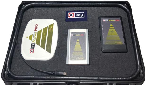
Der "Q-KEY" wird in einem stabilen Hartschalenkoffer ausgeliefert. Er beinhaltet die Stromversorgung (**Battery Pack**, Gerät links), den **Q-KEY Schlüssel Scanner** (das Gerät in der Mitte), die **Q-KEY Car Unit** (rechtes Gerät) sowie die schwarze Richtantenne, um den Original Fahrzeugschlüssel zu veranlassen, seine Daten zu senden.
